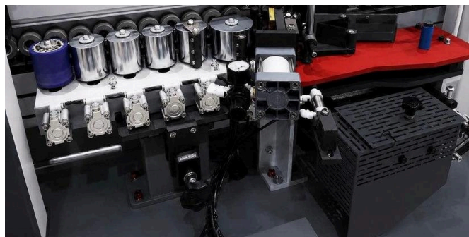
CREUZETUL EVA ȘI ZONA DE PRESARE CU MAI MULTE ROLE, CU ÎNCĂRCARE PNEUMATICĂ
