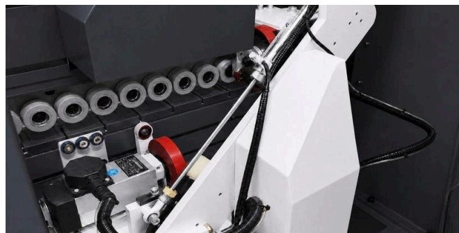
CĂRUCIORUL DE RETEZARE, CU GHIDAJ DE COPIERE ȘI SUPORT PENTRU CANT
