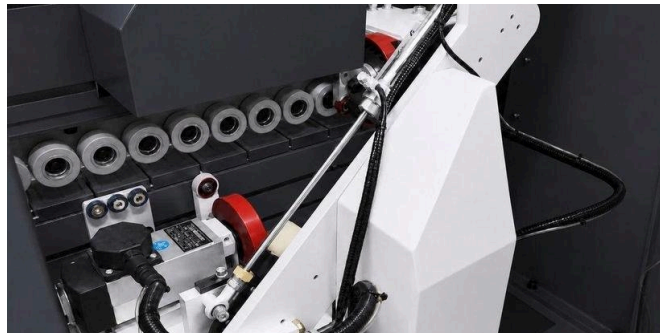
КОЛИЧКАТА ЗА ЧЕЛНО ОБРЯЗВАНЕ, С КОПИРАЩ ВОДАЧ И ОПОРА ЗА КАНТА
