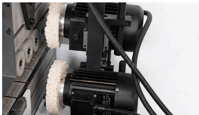
АГРЕГАТ ЗА ПОЛИРАНЕ — ДВА МОТОРА ПО 0,37 КВТ С ТЕКСТИЛНИ ДИСКОВЕ
