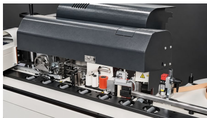
GRUPURILE DE LUCRU SUB CARCASĂ: ALIMENTAREA CANTULUI, ROLA DE ÎNCHIEIERE, ROLELE DE PRESARE ȘI RETEZAREA CAPETELOR
