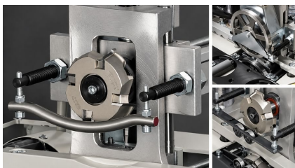
FREZARE LA NIVEL SUS / JOS CU FREZE Z4 DE 75 MM ȘI COPIATOARE CU DISC
