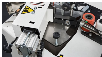
ПНЕВМАТИЧНА НОЖИЦА ЗА КАНТ НА РОЛКА И ЗОНА НА ЗАЛЕПВАНЕ
