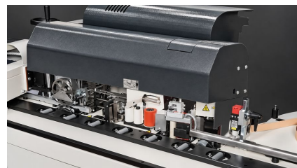
РАБОТНИТЕ АГРЕГАТИ ПОД КАПАКА: ПОДАВАНЕ НА КАНТА, ЛЕПИЛЕН ВАЛЯК, ПРИТИСКАЩИ ВАЛЯЦИ И ЧЕЛНО ОБРЯЗВАНЕ
